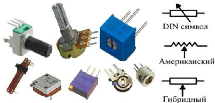
Рис. 10. Переменные резисторы (потенциометры)
