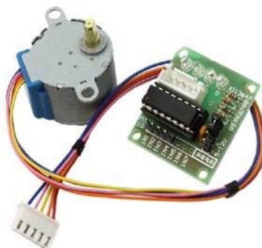
Рис. 20. Шаговый двигатель 28BYJ-48
