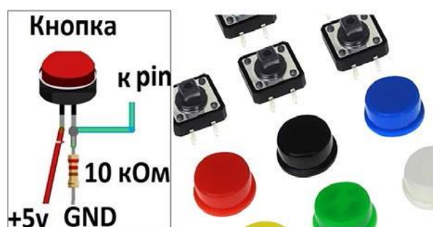
Рис. 1. Схема подключения тактовой кнопки к микроконтроллерной плате
