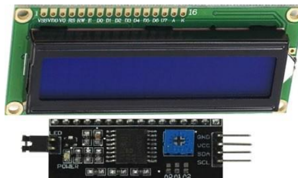
Рис. 17. Дисплей (жидкокристаллический индикатор — ЖКИ 16x2)
