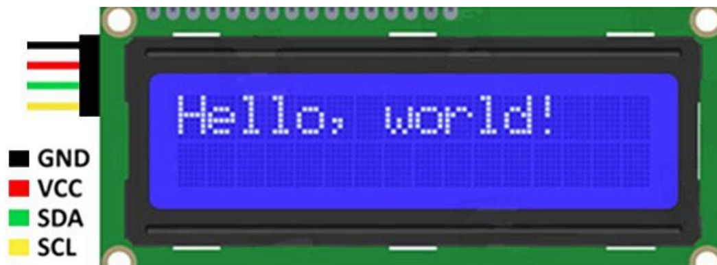
Рис. 1. Подключение модуля ЖКИ к Ардуино
